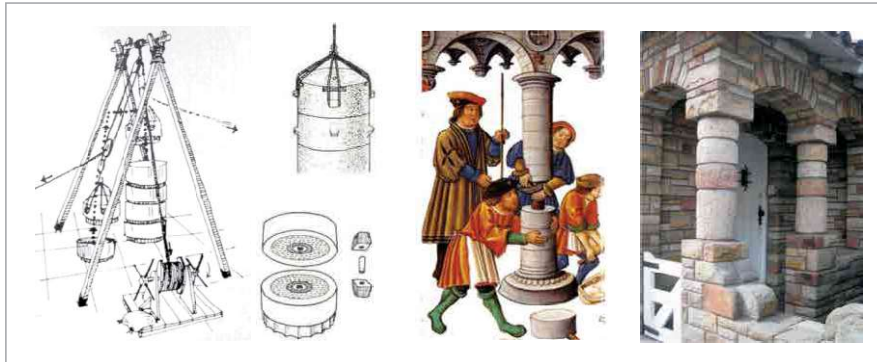
Cabria: proceso de izado de sillar en antigua Grecia, tetones y cuñas. Reparación de columna de tambores, Manuscrito del siglo XVI columnas de tambor en porche de chalet, Mar del Plata.
